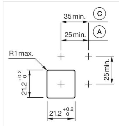
A = Löt-/Steckanschluss 2,8 mm x 0,5 mm
