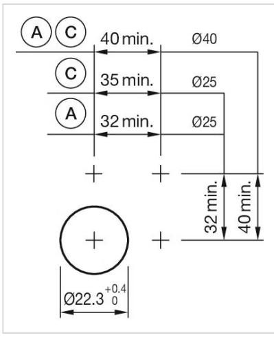
A = Löt-/Steckanschluss 2,8 mm x 0,5 mm
