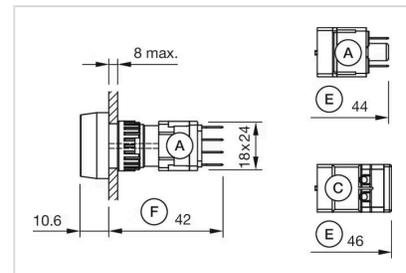
A = Steckanschluss 2,8 mm x 0,5 mm
