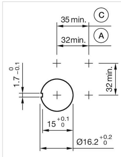
A = Löt-/Steckanschluss 2,8 mm x 0,5 mm
