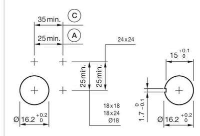
A = Löt-/Steckanschluss 2,8 mm x 0,5 mm
