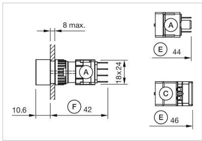
A = Steckanschluss 2,8 mm x 0,5 mm
