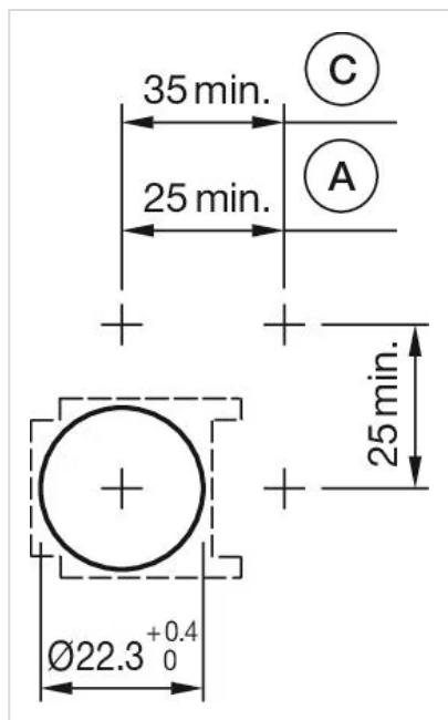
A = Löt-/Steckanschluss 2,8 mm x 0,5 mm
