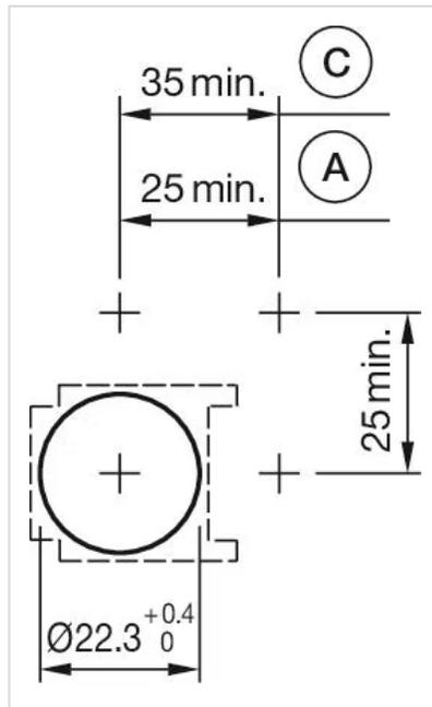
A = Löt-/Steckanschluss 2,8 mm x 0,5 mm
