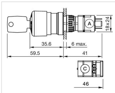
A = Steckanschluss 2,8 mm x 0,5 mm
