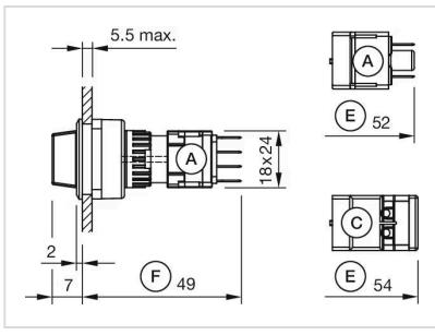
A = Steckanschluss 2,8 mm x 0,5 mm
