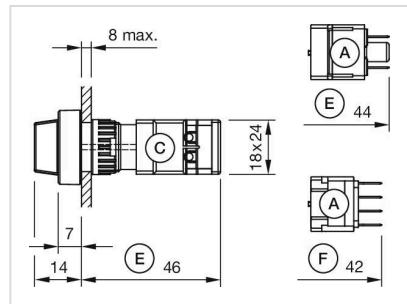
**A** = Steckanschluss 2,8 mm x 0,5 mm
