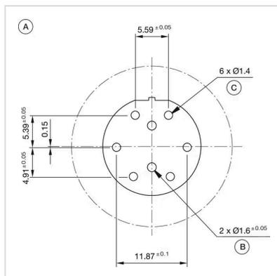
A = Bohrplan (Bauteilseite)
