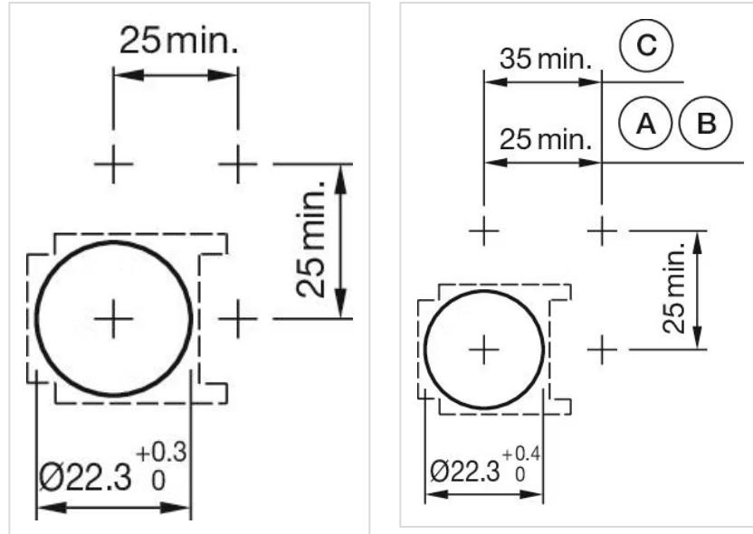
A = Löt-/Steckanschluss 2,8 mm x 0,5
