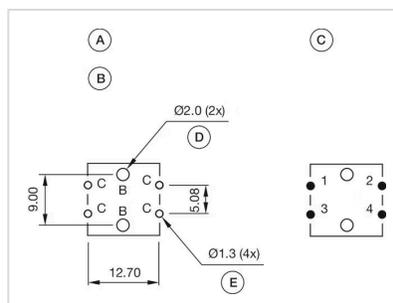
A = Schaltelement ohne Ausleuchtung mit Zentrierung
