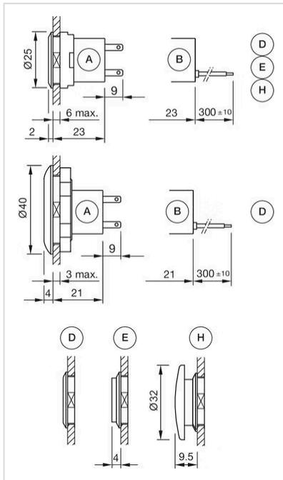
A = Steckanschluss 2,8 mm x 0,8 mm
