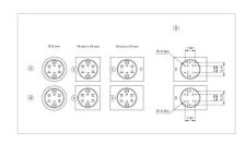
A = ユニバーサル端子 (背面) B = プラグイン端子 (背面) C = 逆回転阻止装置 D = 穴あけ配列(コンポーネント側)
