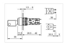
A = 半田端子 B = プラグイン端子 2.8 mm x 0.5 mm C = ユニバーサル端子 2.0 mm x 0.5 mm
