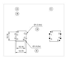
A = 照光付きスイッチエレメント B = 単一LED C = 穴あけプラン (部品側) D = スイッチエレメント用穴、パッド最 大② 2.5 mm
