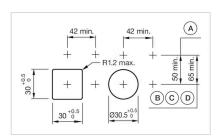
A = ねじ端子 B = スプリングケージ端子 (PIT) C = プラグイン端子 6.3 mm x 0.8 mm D = ダブルプラグイン接続 6.3 x 0.8 mm
