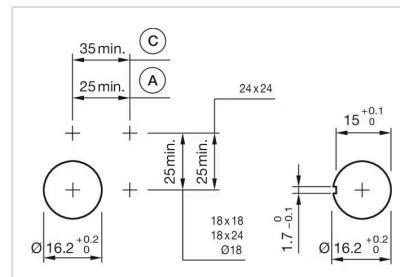
A = 焊接/插入式端子 2.8 mm x 0.5 mm
